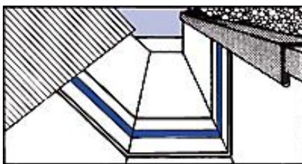
Endlosband in Rinne im Innendach eingebaut
