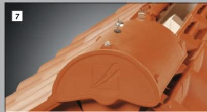
Dichtscheibe und Klemmkralle werden auf den zusätzlichen Firstklammerdraht gesteckt. Der Draht wird durch Zug gespannt und die Klemmkralle nach unten auf den Firstziegel geführt.
