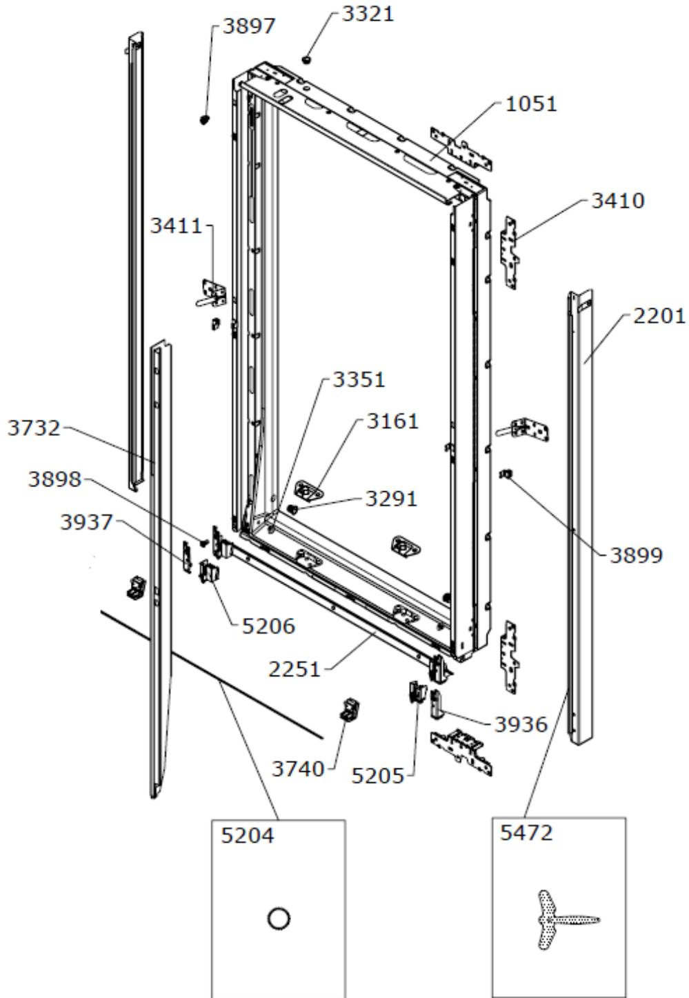
Flügel komplett, Zwischenrahmen, Dichtungen
