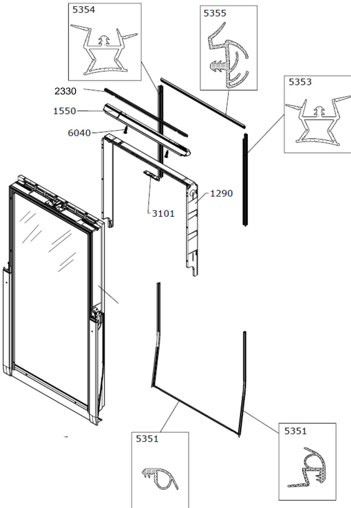
Flügel ohne Scheibe, Beschläge, Dichtungen, Kleinteile, Lüftungsklappe mit Griffleiste
