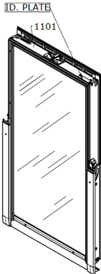
Flügel ohne Scheibe, Beschläge, Dichtungen, Kleinteile, Lüftungsklappe mit Griffleiste
